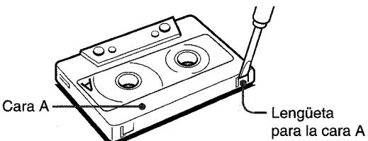
Para volver a grabar en una cinta, tape las aberturas con cinta adhesiva, etc.
